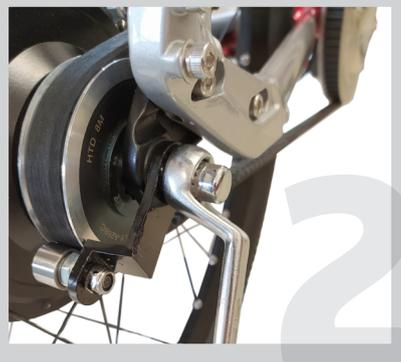
2 - Vélo posé sur le sol, démontez l'écrou coté droit et enlevez patte de fixation de la poulie. Puis, démontez l'écrou coté gauche
