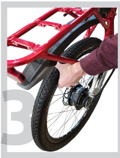
4. Pour remettre la roue, alignez la **rondelle ergot** avec la patte du cadre.
